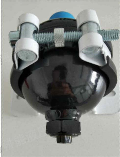
隔膜式蓄能器使用油箱喷油现象的解决方法在实际操作中，有时还会遇到油箱喷油的现象，这是由于隔膜式蓄能器气囊受压破碎，大量气泡进入油液中，使油液的可压缩性增加，由于油液从高压突然降为低，流回油箱的油液在箱内急剧膨胀，油箱内的压力高于大气压，使油液混同空气一起从通气孔排出，从而出现喷油现象。怀疑隔膜式蓄能器出现故障时，首先应检查隔膜式蓄能器的充氮压力。此外，如果充氮压力过高，也会出现异常，因为这时隔膜式蓄能器储存的油量太少，满足不了油缸的用量，不能正常工作。为了更好地发挥隔膜式蓄能器对脉动压力的吸收作用，隔膜式蓄能器与主管路分支点的连接管道要短，通径要适当大些，并要安装在靠近脉动源的位置。否则，它消除压力脉动的效果就差，有时甚至会加剧压力脉动。上海耕能液压技术有限公司致力于提供隔膜式蓄能器，有需要可以联系我司哦！西藏火电隔膜式蓄能器减噪
