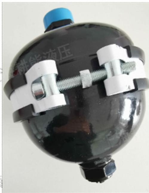
隔膜式蓄能器充气时注意事项当给气囊式和隔膜式隔膜式蓄能器充气时，氮气经常要求非常慢。假如高压氮气允许进入气囊时快速地扩张，它将导致把气囊的聚合物材料变冷到某部位点立即地易碎失效发生。快速充气也会将气囊挤入油端锥形阀下面，导致气囊被切。如果预充气压力过高或者过小系统压力变小而预充气压力没有做相应减少，隔膜式蓄能器的运行将受影响和导致损坏的结果。气囊式隔膜式蓄能器过分的预充气会在泄压时把气囊卡进装配的锥形阀里，导致锥形阀或气囊损坏。这是气囊失效的基本原因。低压或者没有预充气也能是气囊式隔膜式蓄能器过频波动。结果是气囊在系统压力下在壳体顶部起皱损坏。这将导致气囊被气囊被气阀挤入或被刺破。在这种情况下，只需要一个循环就会破坏气囊。一样的，过高或者过低的预充气压力会导致活塞隔膜式蓄能器的活塞到达行程末端的底部，损坏活塞和它的密封。好消息是，假如这发生，一个听的见的警示将产生。即将活塞隔膜式蓄能器能被不合格的充气损坏，它们还是比气囊式隔膜式蓄能器更可以让人容忍。浙江造船隔膜式蓄能器减噪上海耕能液压技术有限公司是一家专业提供隔膜式蓄能器的公司，有需求可以来电咨询！
